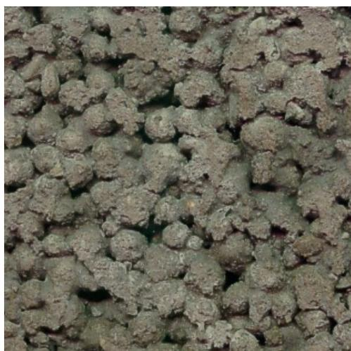
شکل ۲-۲- بتن با ساختار باز
