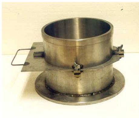
شکل ۶-۴ دستگاه آزمایش ستون جداشدگی
