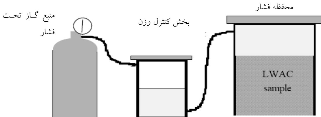
شکل ۳-۶ دستگاه تعیین پمپ‌پذیری بتن به روش فشار-حجم
